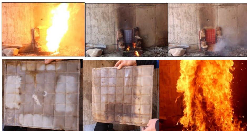
شکل ۱۵. شعله‌ور شدن حریق مواد پرانرژی در تماس مستقیم با کامپوزیت عایق آبروژل، هیچ‌گونه تخریب یا افزایش دمای آسیب‌زننده در طرف دیگر کامپوزیت مشاهده نشد.
