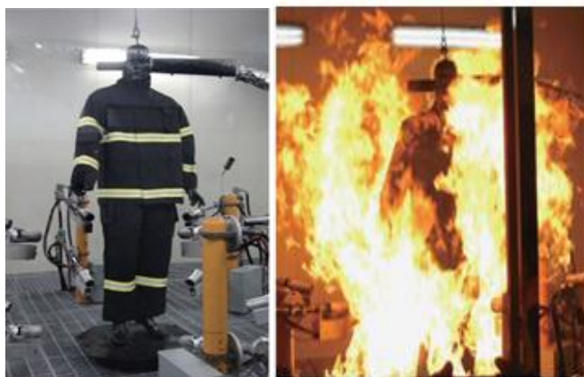
شکل ۳. آزمون شعله مستقیم مانکن با دمای حدود ۱۱۰۰ درجه سلسیوس [۱۷].
