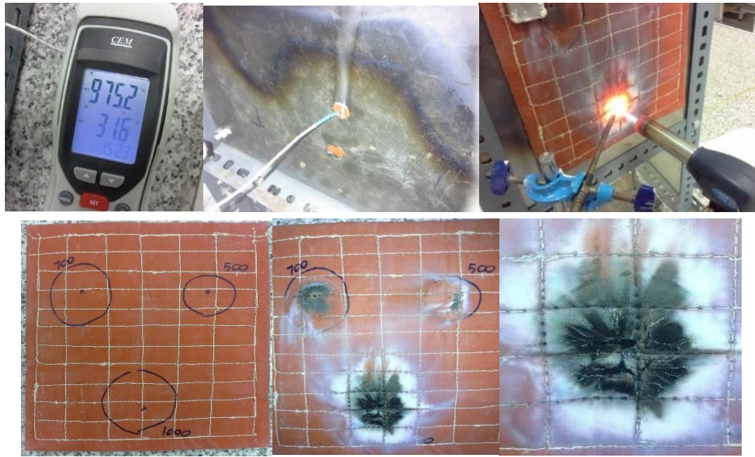
شکل ۱۰. آزمون‌های شعله مستقیم انجام شده در دماهای مختلف بر روی کامپوزیت آبروژل با ضخامت ۳ میلی‌متر منعطف. Figure 11. Testing of the aerogel composite with 3mm thickness at different temperatures.
