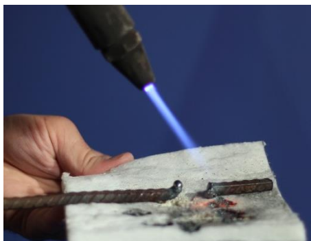
شکل ۵- تحمل دماهای بسیار بالا بدون دود و مواد سمی و ایجاد اختلاف دمای بیش از ۱۰۰۰ درجه سانتیگراد به ازای یک سانت بلنکت آبروژل
