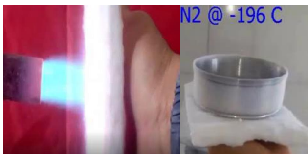
شکل ۱۷- عملکرد عالی در بازه دمایی منفی ۲۰۰ الی مثبت ۶۵۰ درجه سلسیوس به صورت پایدار و با کمترین ضخامت
