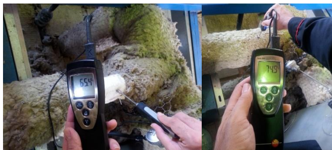
شکل ۶- مقایسه دمای سطح ۱۰ سانت پشم سنگ با یک سانت بلنکت آبروژل (دمای سیال ۲۸۰ درجه سلسیوس)
